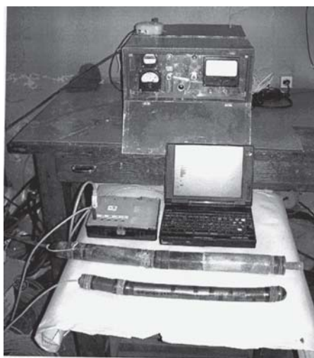
Рис. 1. Установка для сейсмоакустических исследований качества грунтоцементных свай. На переднем плане погружаемые в скважину электроискровой излучатель и приемник колебаний
