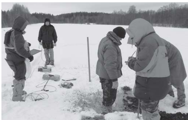
Рис. 1. Рабочий момент георадиолокационной съемки. Георадар «ОКО-2М», антенный блок АБ-250
