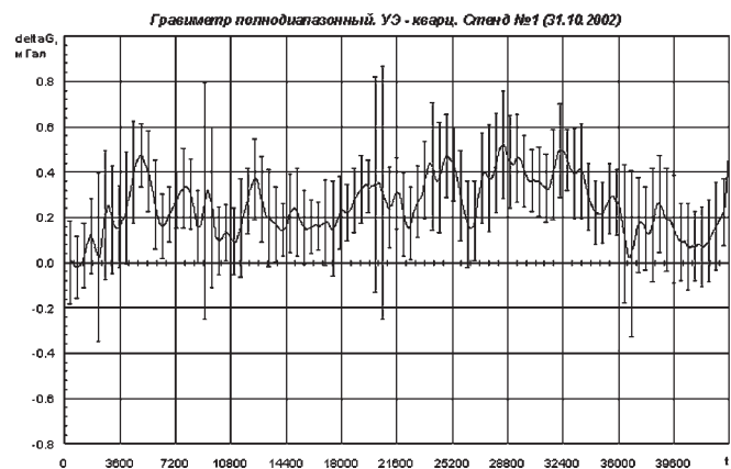
Рис. 3. Результаты измерений полнодиапазонным гравиметром с кварцевым упругим элементом
