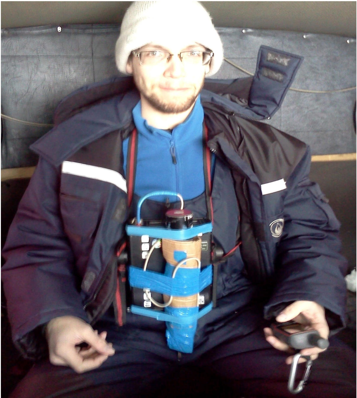
Рисунок 5. Вольтметр ЭРА-МАХ с феррозондом на 625 Гц у оператора Юры Курдюкова
